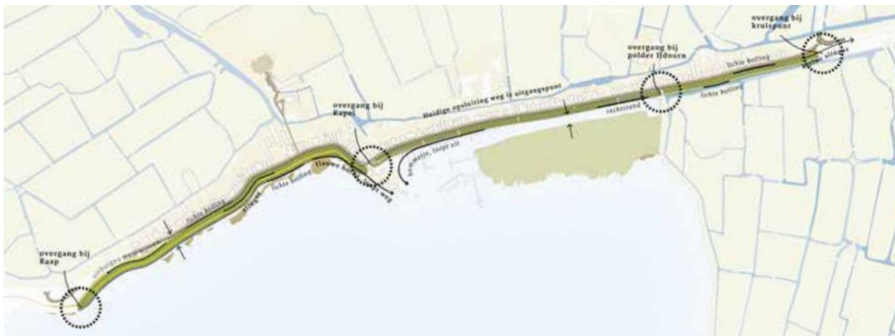
Logische plekken voor overgangen in het dijkprofiel
