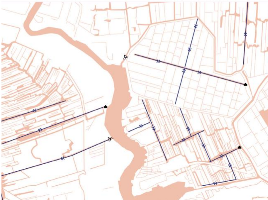
Figuur 2-16: Schematisatie van het watersysteem in de Engewormer en Kalverpolder. De locatie van de bemaling is aangegeven.
